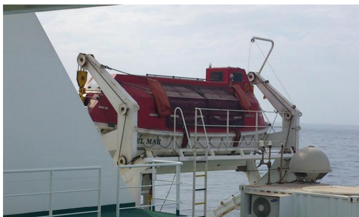
Fot. 14. Bote de rescate rápido de estribor del Esperanza del Mar tipo Pesbo BS-30M. Fuente: Propia.
