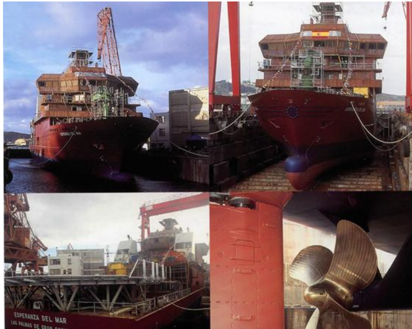
Fot. 1. El Esperanza del Mar en el proceso de construcción. Fuente: Mery Varona, Buque Hospital Esperanza del Mar , Instituto Social de la Marina.
