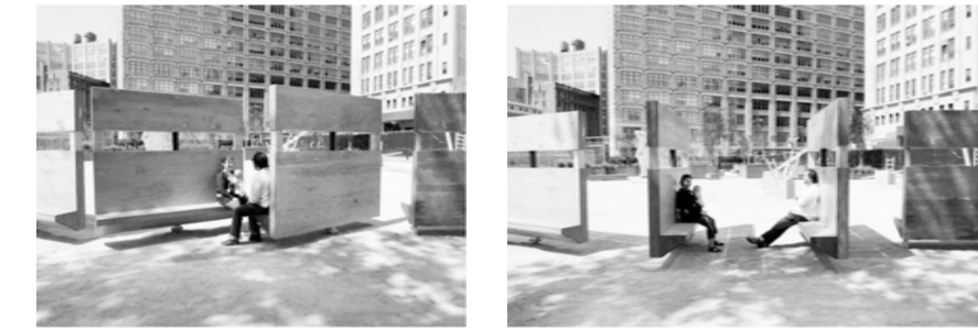
Moviment pivotant de panells que permeten càrrega a sobre
