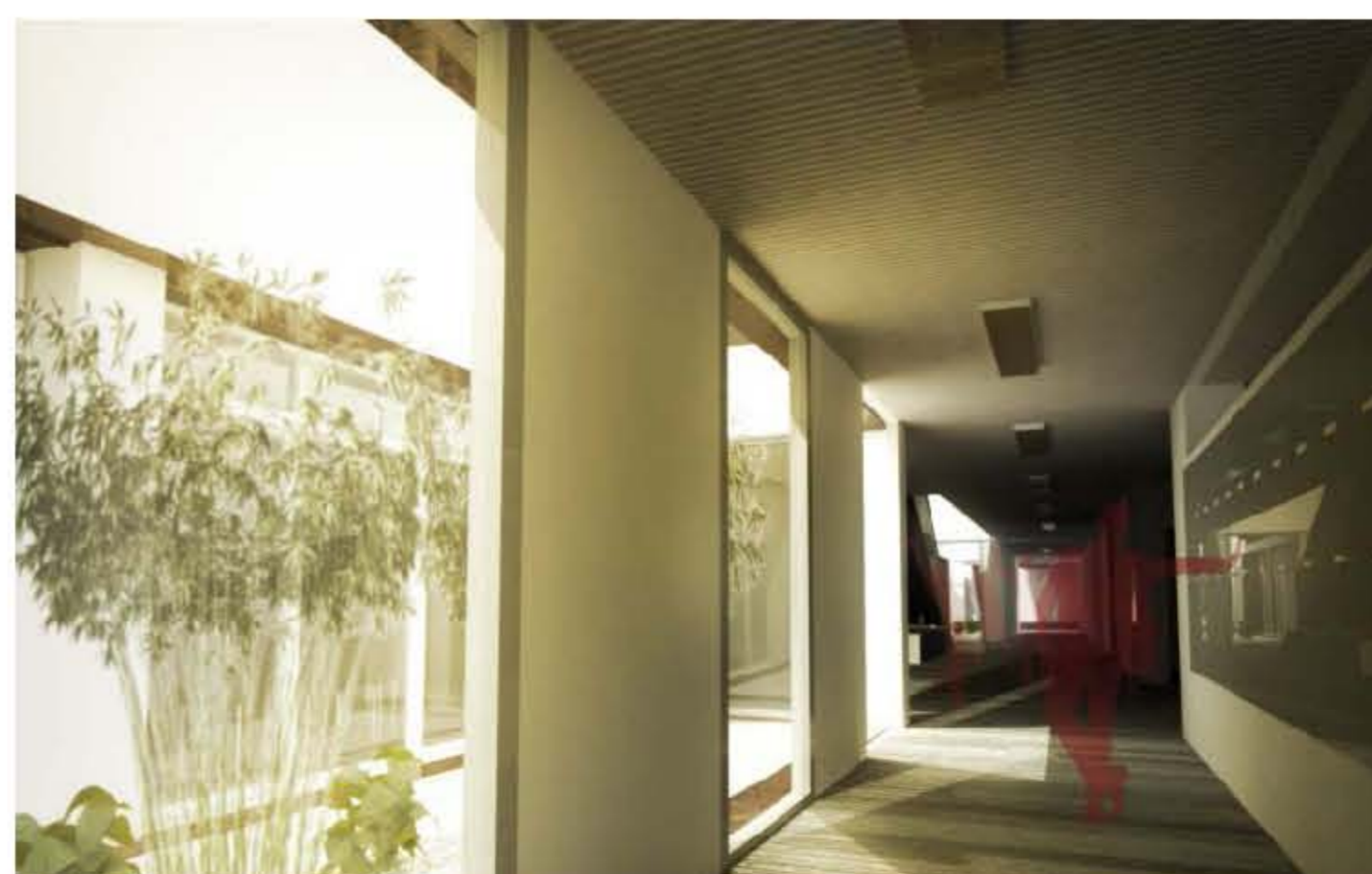
3 Es projecten entrades de llum natural mitjançant patis al mig del mòdul. Aquests juguen amb la disposició a portell dels envans i finestres per tal d'aconseguir intimitat a les aules.
