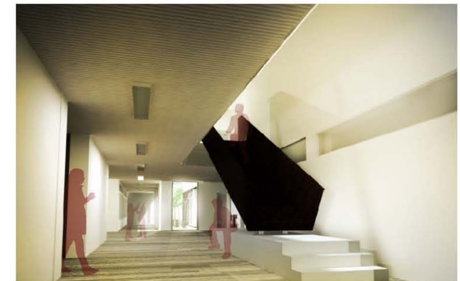
4 Escala lleugera d'acer corten que crea un espai lliure al seu voltant potenciat per la entrada de llum per lluernari que disposa. A més, els primers graons formen un atri de formigó on la gent es pot asseure.
