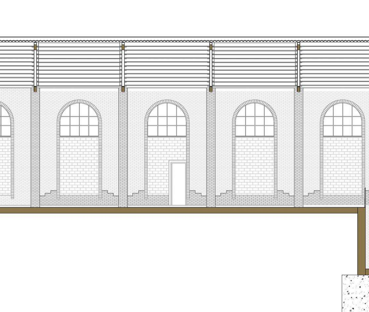
En conclusió: el que principalment es conservarà de la antiga alcoholera és l'esquelet estructural (una llum de 15 m, pilars de ma'o de 45x45 cm, encavellades i corretges de fusta i un mur de 60 cm de gruix), els nivells dels diferents pisos i el gran espai interior que ofereix la nau.
