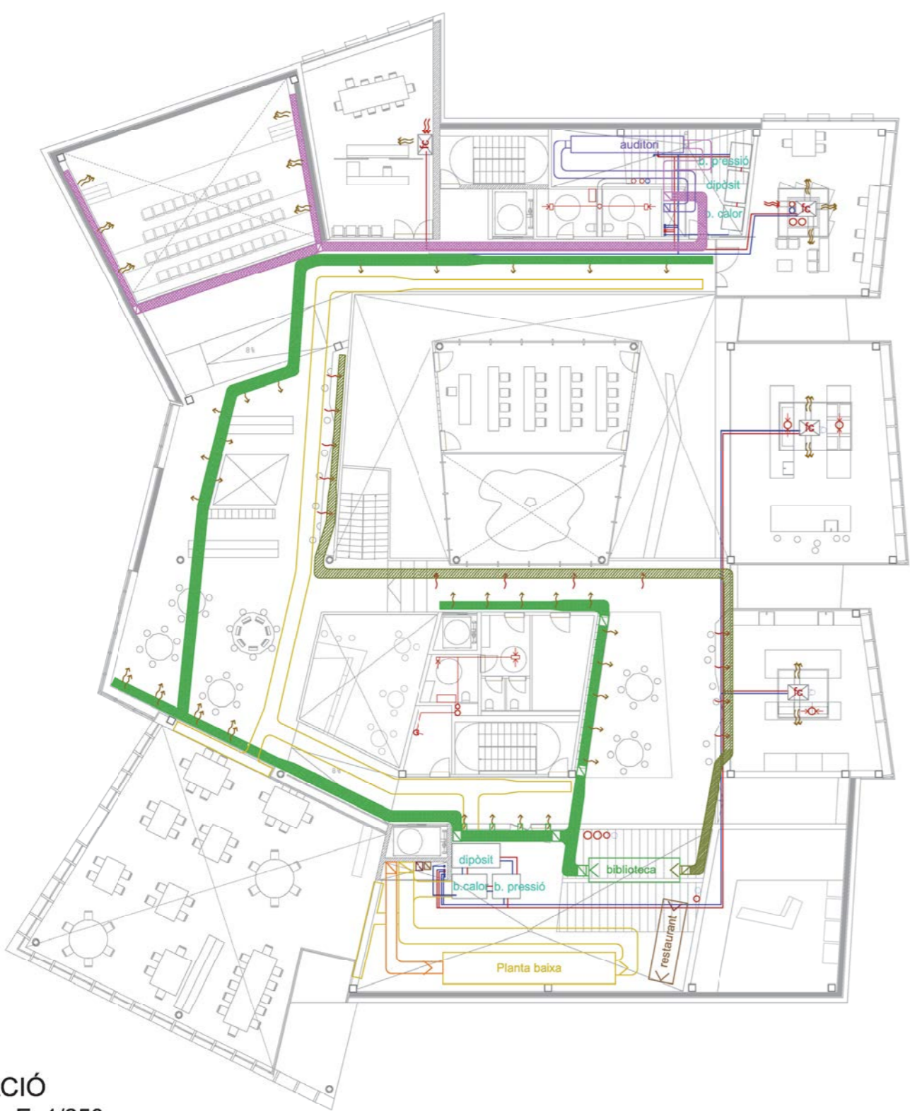
CLIMATITZACIÓ Planta baixa, E 1/250
