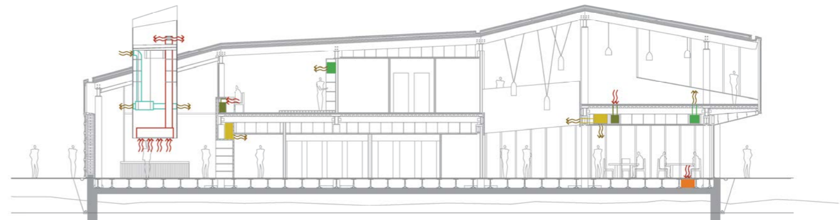
Clima i extracció de fums Secció E-O, E 1/200
