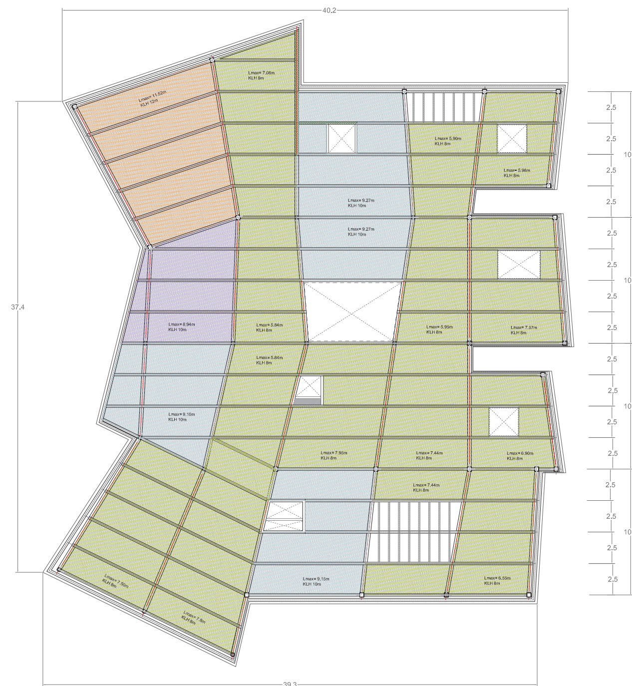
Panells KLH E 1/300 panells de fusta contralaminada
