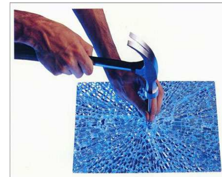
Fig. AN.10 Imagen de la rotura de un vidrio templado en multitud de pequeños fragmentos
