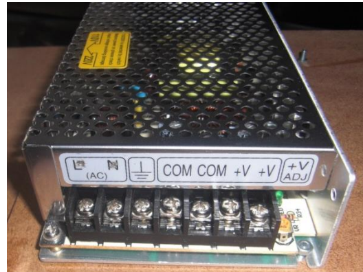
Fig.6. Fuente alimentación conmutada
