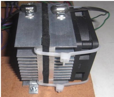
Fig.4. Imagen de montaje del refrigerador
