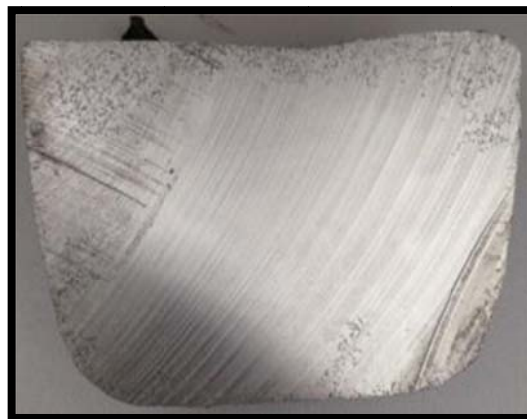
Fig.1 Imatge del tall transversal realitzat després de la prova 1 del material obtingut, en que es poden distingir els diversos punts negres al voltant del perímetre de la figura que representen el Si primari de l'aliatge.
