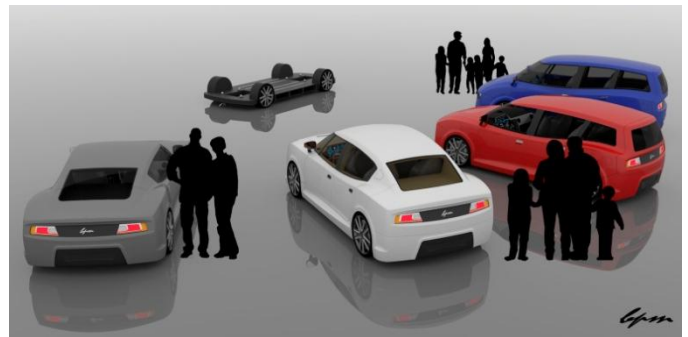
Fig. 5 Imatge de les 4 carrosseries dissenyades per aquest projecte que comparteixen la mateixa plataforma i estan adaptades a diverses necessitats dels usuaris.
