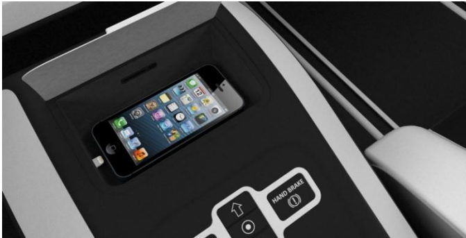
Fig. 8 Imatge de l'allotjament del "smartphone" en la consola central situada entre els seients del conductor i acompanyant.
