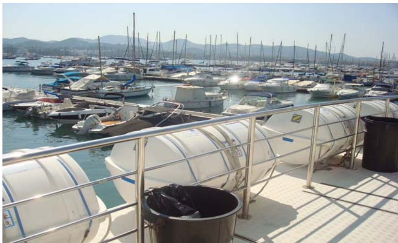
Fig.6. Balsas salvavidas situadas en la cubierta superior
