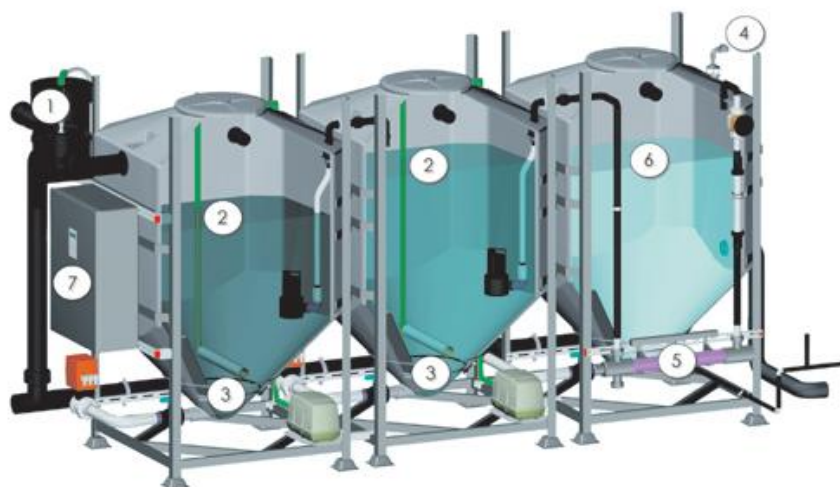
Figura 7.4: Sistema de regeneració d'aigües grises en tres fases. FONT: Aguapur
