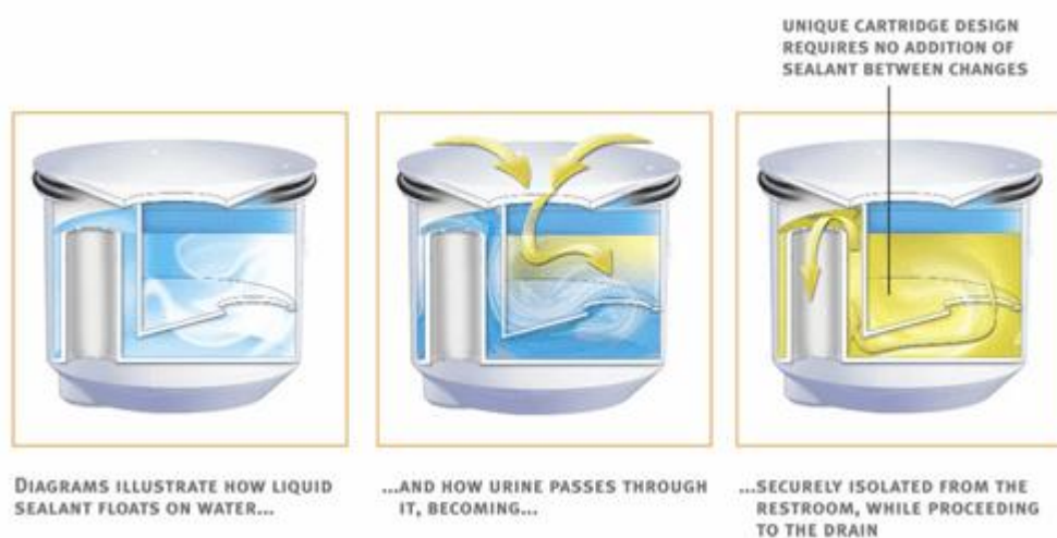
Figura 7.1: Funcionament urinari sense aigua. FONT: Falcon Waterfree
