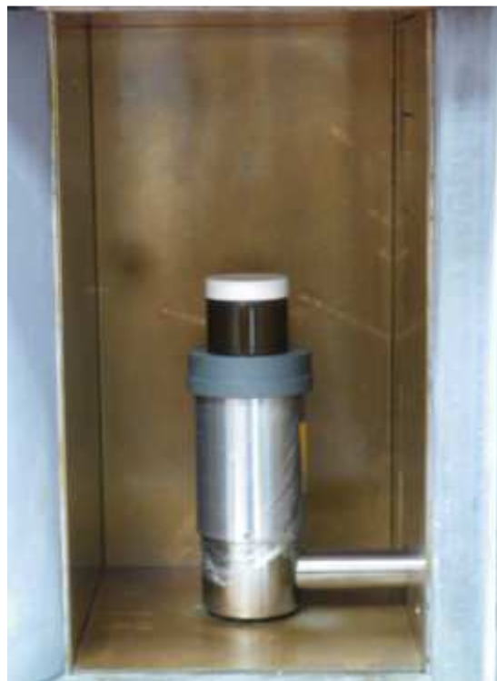
Figura 3.9: Imatge del detector HPGe on s'aprecia el tap per col·locar suports, el pvc que el recobreix i, en aquest cas, un pot de pvc amb una mostra radioactiva
