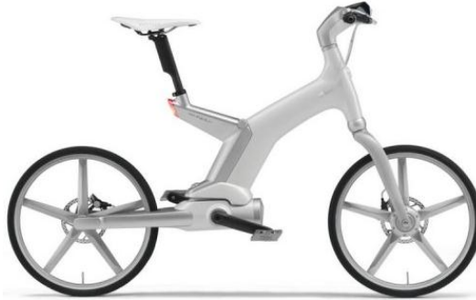
Figura 4. Prototipo Yamaha PAS ER con el motor en el eje de pedalier.
