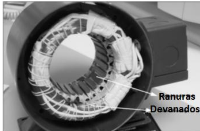
Figura 12. Estator de un motor Brushless.
