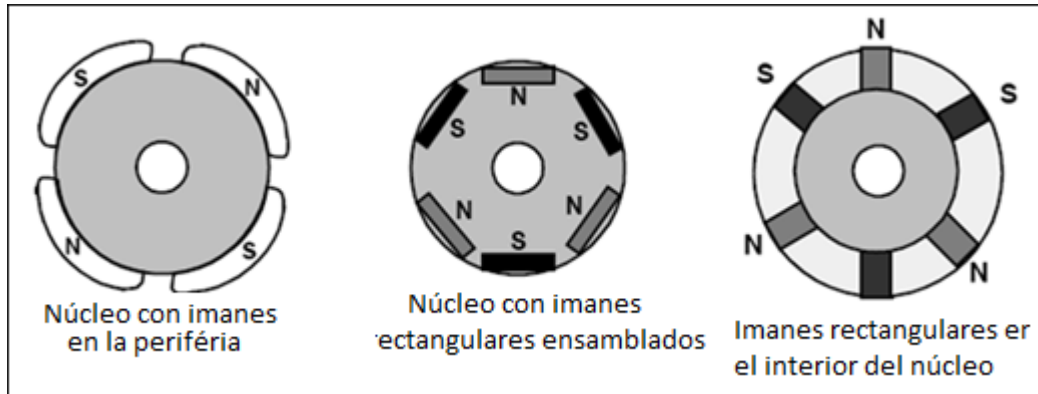
Figura 15. Diferentes configuraciones de los imanes en el rotor.
