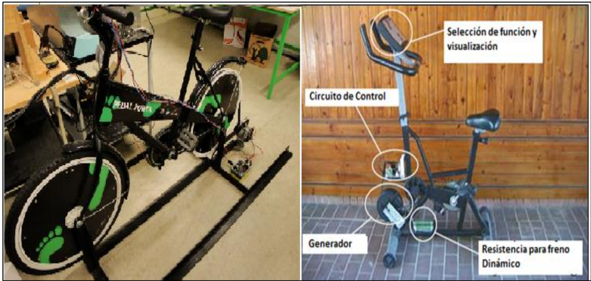
Figura 39. Ejemplos de bicicletas estáticas generadoras de energía.
