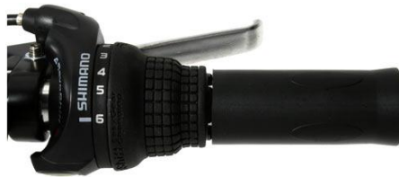
Figura 6. Cambio de velocidades en el puño.
