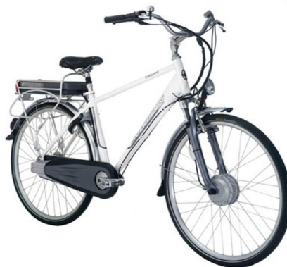
Figura 5. Bicicleta con Motor hub delantero
