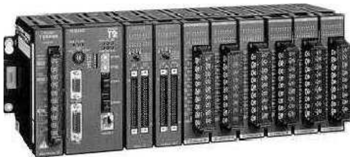
Figura 52. Aspecte d'un PLC. (manual PLC S7 SIEMENS)
