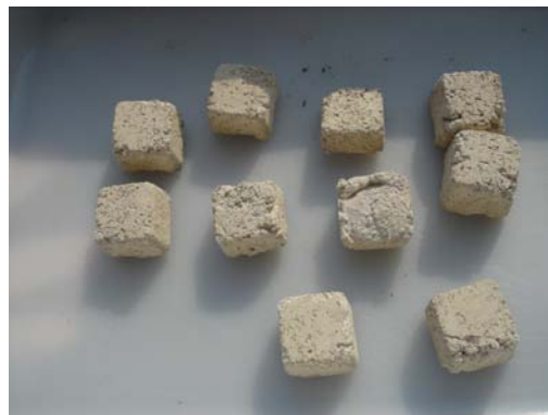
Imagen 12.2: Aspecto estructural y característico de los biocarriers
