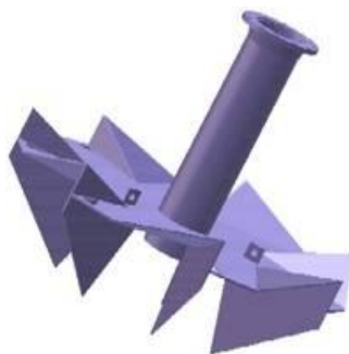
Figura 13. Aireador de superficie
