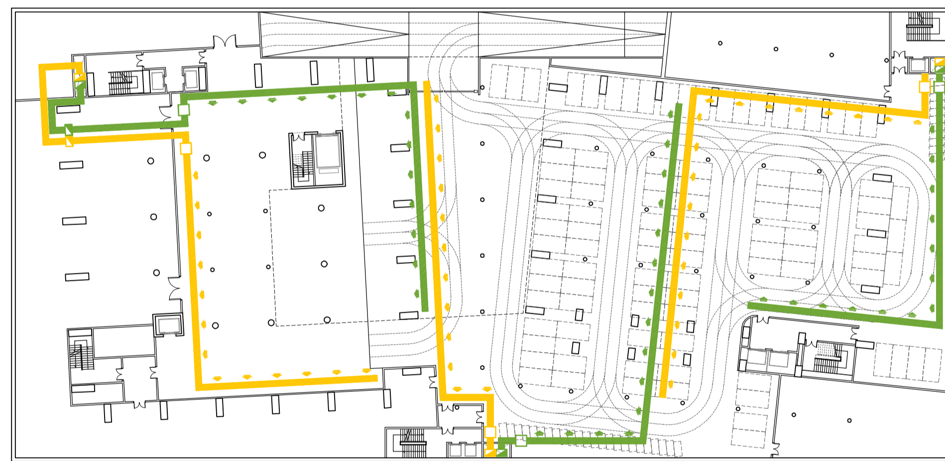
aparcament: renovació d'aire amb caixes extractores
