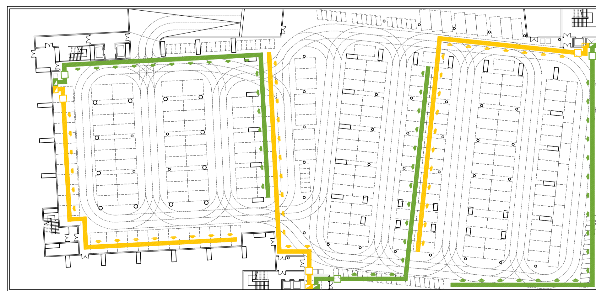
aparcament: renovació d'aire amb caixes extractores
