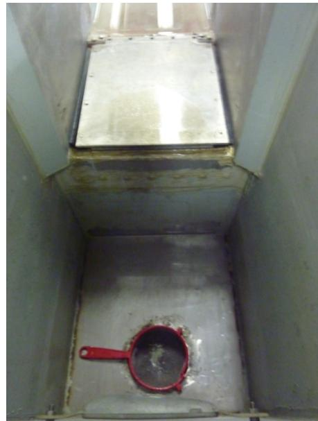
Ilustración 5. Detalle de la compuerta en posición horizontal y filtro de partículas
