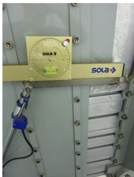
Ilustración 4. Detalle medición inclinación en el brazo mecánico
