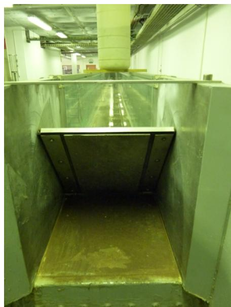
Ilustración 1. Detalle compuerta levantada
