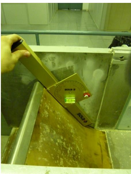
Ilustración 3. Detalle medición inclinación de la compuerta
