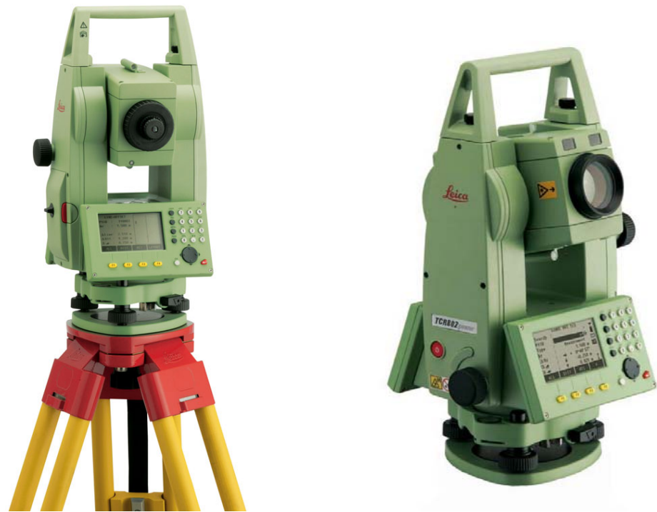
4.2 Estación total modelo TCR 403 de LEICA
