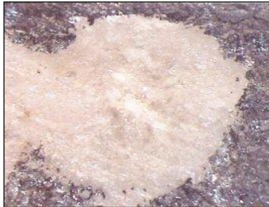
Figura 2.5: Limpieza con láser pulsado IR
