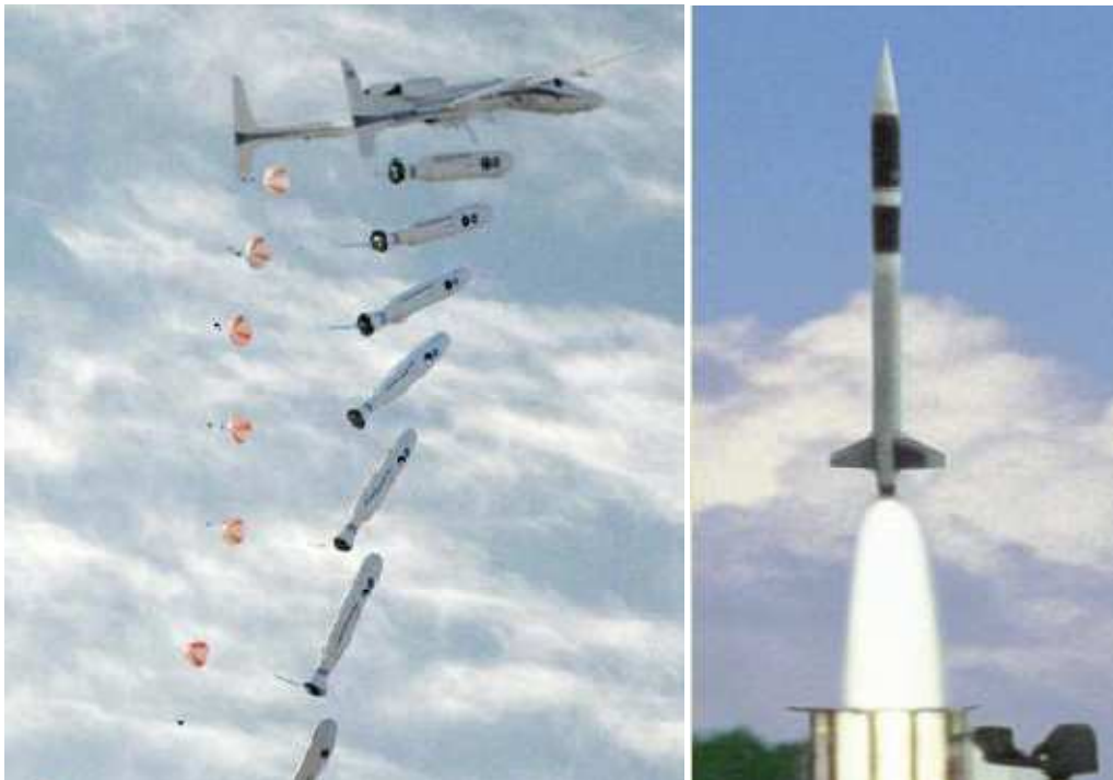
Figura 2. A l'esquerra sistema de llançament aerotransportat, a la dreta coet suborbital
