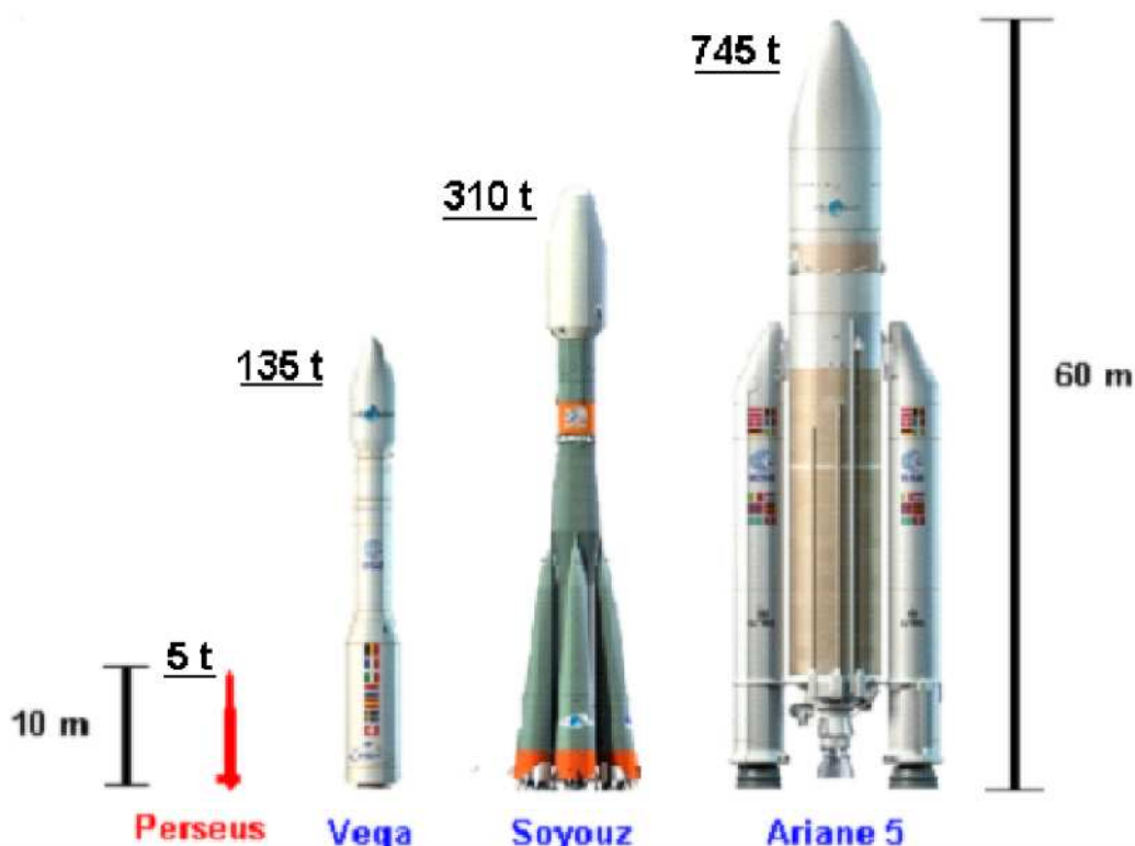
Figura 1. Comparació de mida i pes entre diferents coets espacials i el proposat pel projecte Perseus
