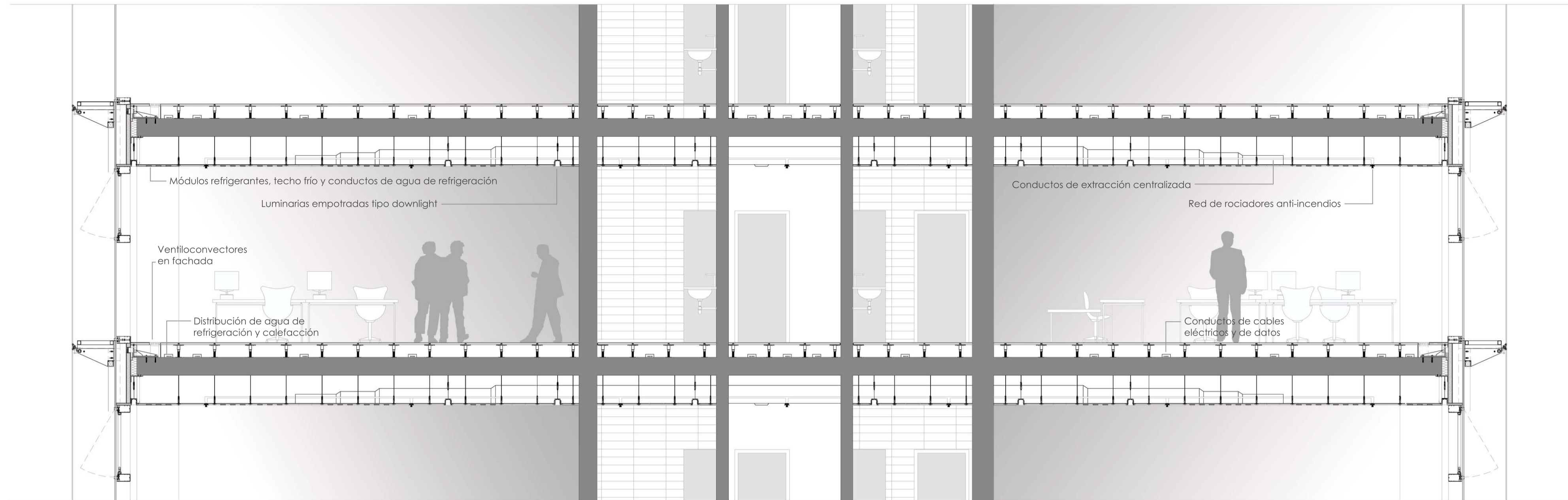
Sección transversal del edificio. Planta tipo. Escala 1/50
