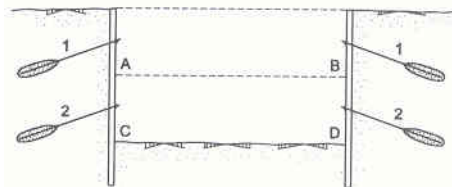
Figura 8.4. Ancoratge de les pantalles
