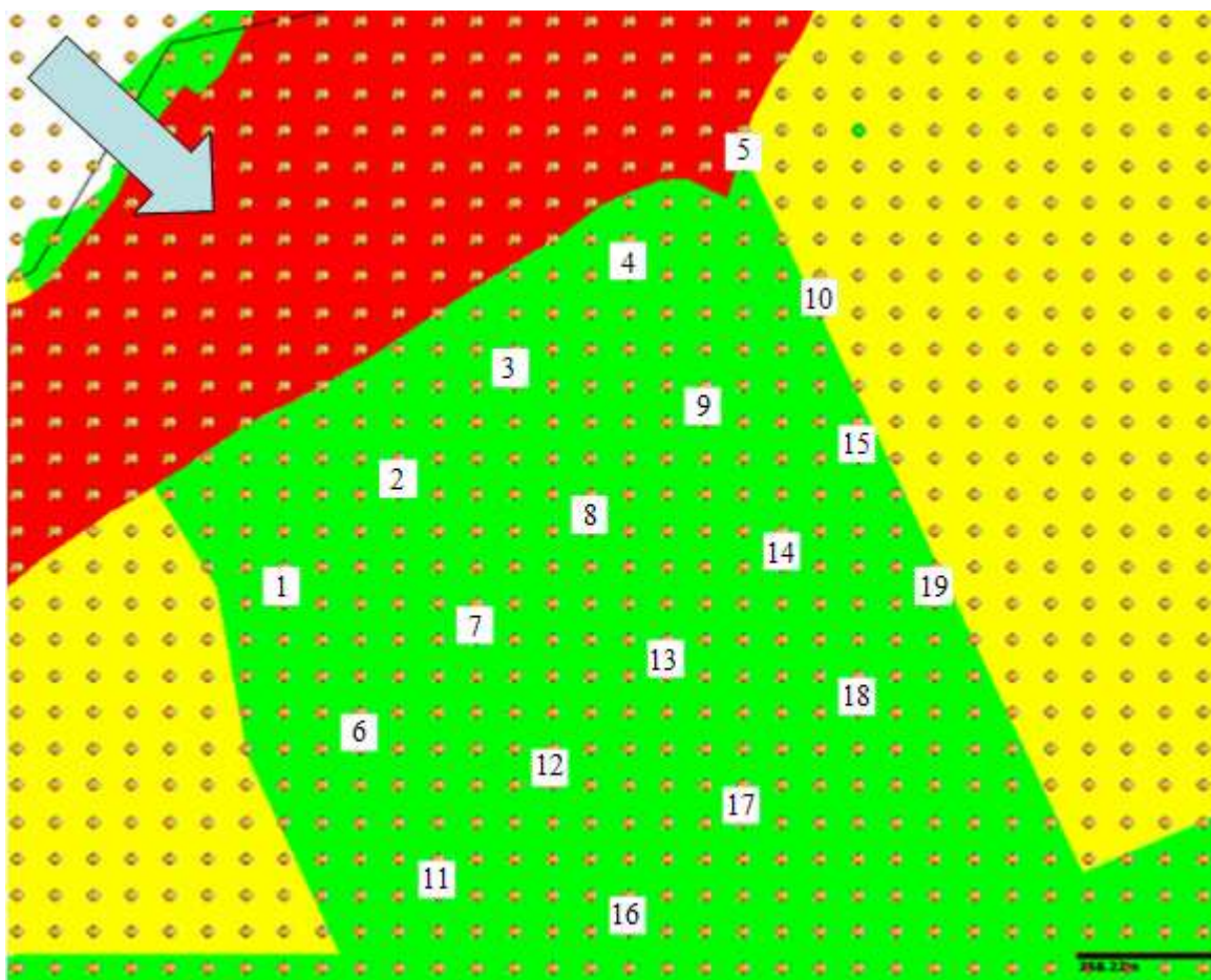
Fig. 7.4. Representació de la ubicació de cada molí, assignant a cada aerogenerador una numeració determinada. Els punts marrons són els nodes dels que s'ha extret el recurs eòlic, i formen quadrats de 100 m. de costat [Font: programari del Atlas Eólico de España ]
