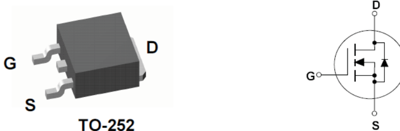
Figura 27. Figura il·lustrativa del MOSFET utilitzat en el pont trifàsic del TestBed
