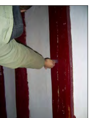
Procés de mesura de les clivelles de les bigues en bon estat. Biga 5 Biblioteca.
