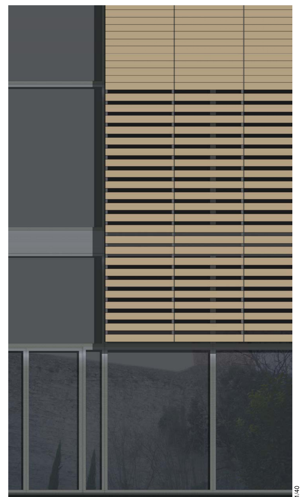
FOTOMUNTATGE_DETALL FAÇANA SUD (lames ceràmiques)
