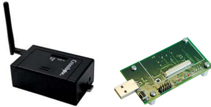
Figura 2.3. Estación base Crossbow MIB520 dentro y fuera de la carcasa
