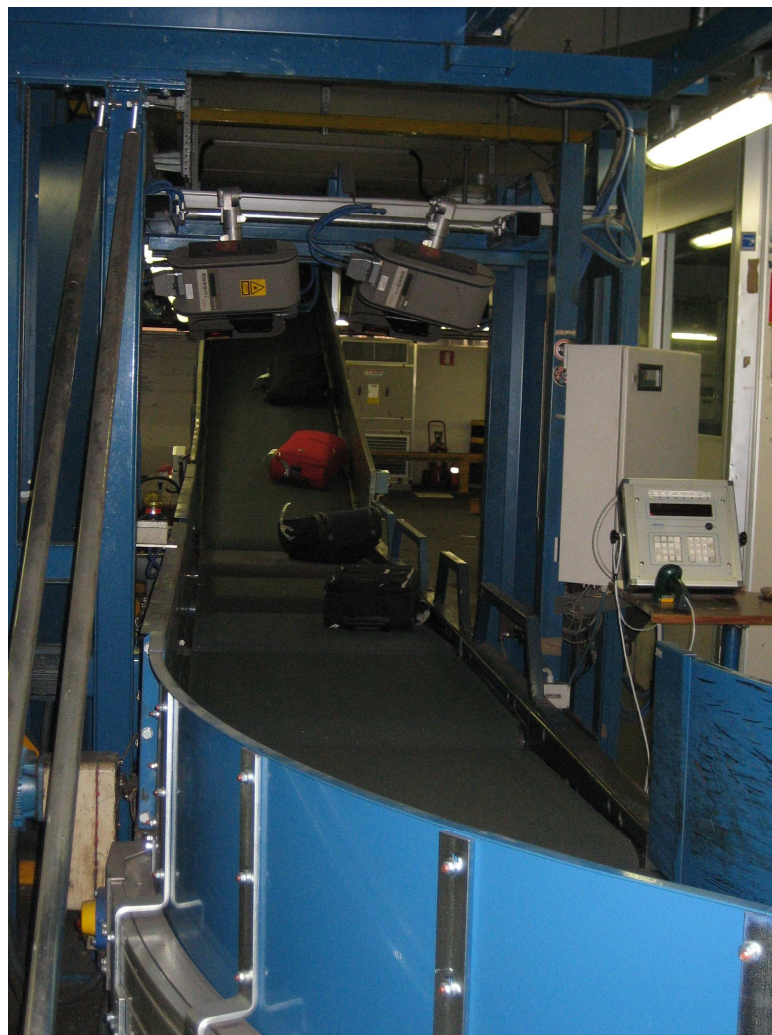
Figura 20: lettura laser dell'etichette dei bagagli; in caso contrario, l'addetto provvederà con l'apposito lettore pistola
