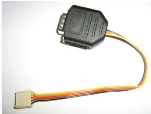
**Fig. B.1** Conector del RS232 para comunicar los nodos con un PC
