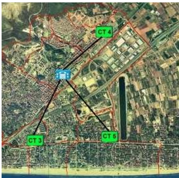
Figura 34: Interconexión de las centrales destinadas a clientes empresariales mediante tecnología MetroEthernet.
