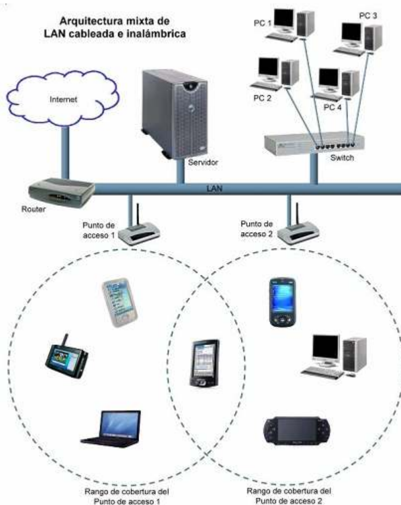
Figura 8: Arquitectura mixta de LAN cableada e inalámbrica
