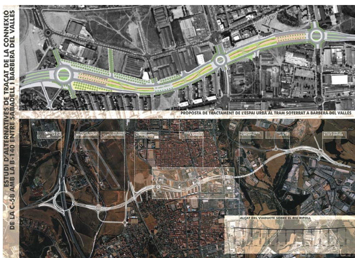
Fig. 6.3: Conexión viaria entre dos carreteras utilizando una vía segregada a su paso por una población. A lo largo de toda la traza se observan diferentes tipos y tamaños de rotondas en función de las necesidades.
