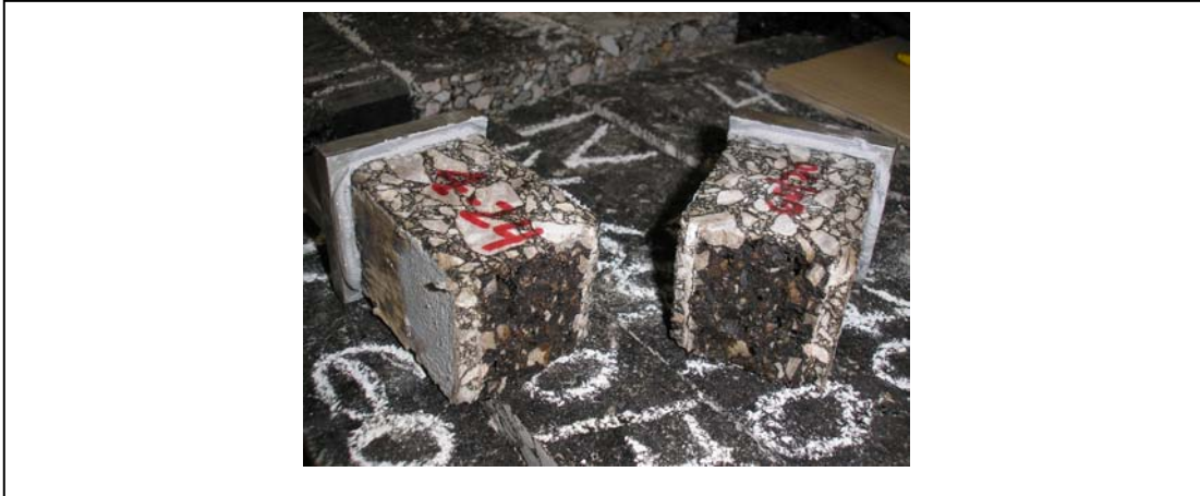
Figura 3.10.- Rotura de la probeta por la zona de muescas
