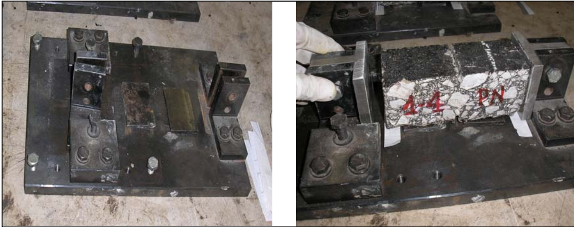
Figura 3.11- Proceso de fijación de las placas de los extremos de la probeta prismática
