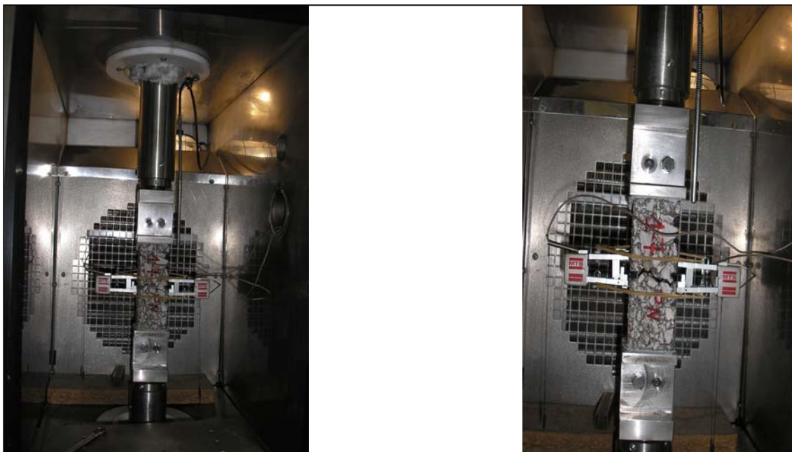
Figura 3.12.- Ensayo a tracción directa de la probeta prismática
