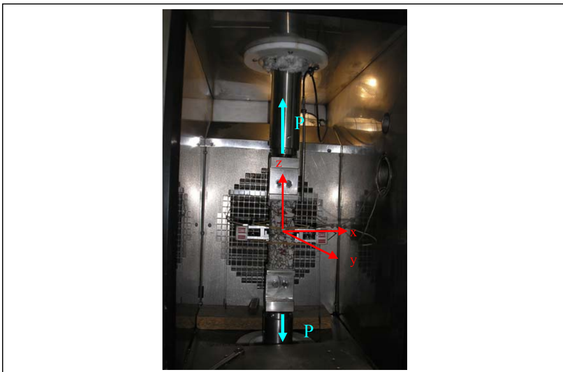
Figura 3.9- Ensayo de tracción simple, con el eje de carga en la dirección del eje z
