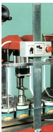
Fig. 3.7. Cerrador de tapas presión
