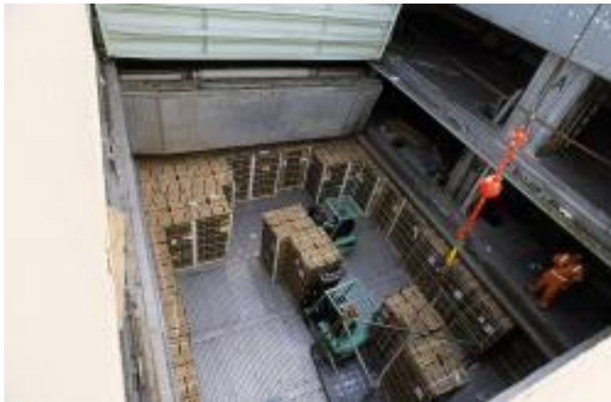
Figura 13: Estiba de pallets en un entrepunte
