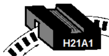
Figura 22. Disposición del optoacoplador y el encoder.
