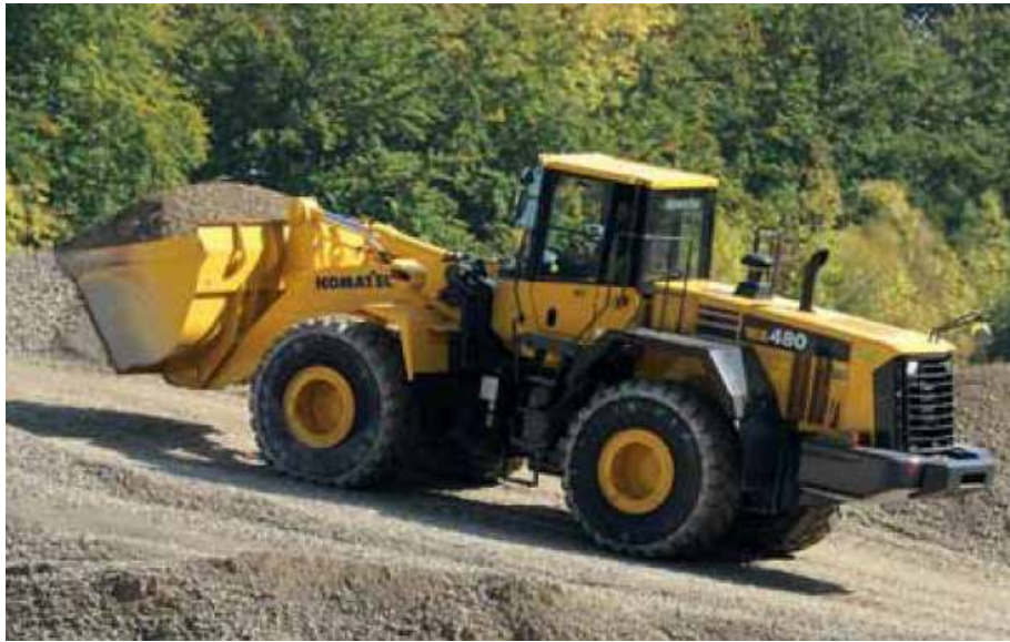
Figura. 33. Pala cargadora de áridos Fuente: Elaboración propia
