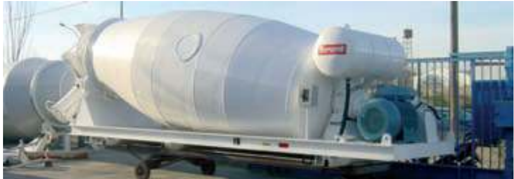
Figura. 34. Cuba transporte de hormigón Fuente: Elaboración propia
