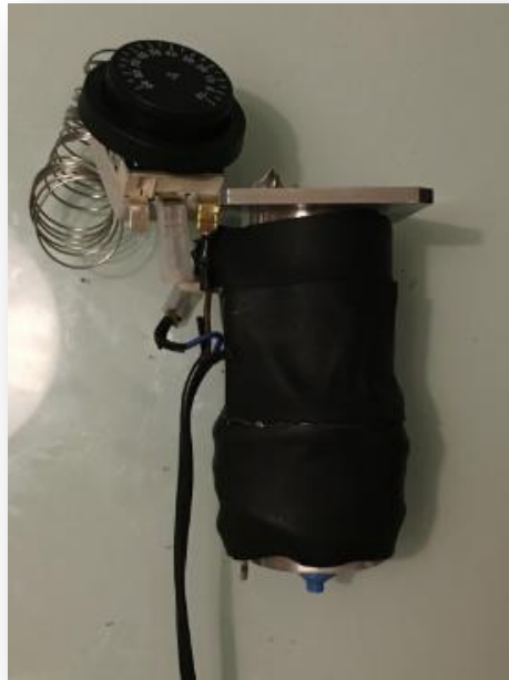
Figura 5.1. Cilindre amb el sistema de control de temperatura.
