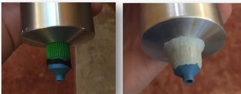
Figura 5.9. Punta extrusora fixada amb massilla segellant.
