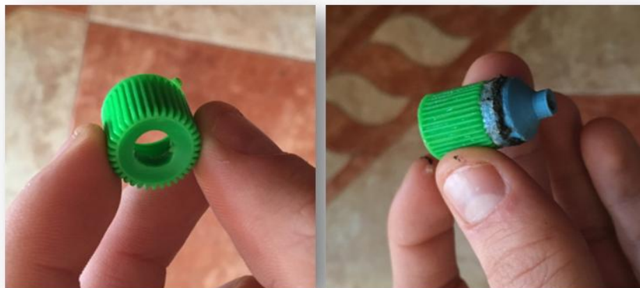
Figura 5.8. Tap foradat amb la punta extrusora.
