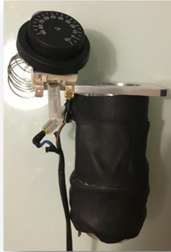
Figura 4.9. Cilindre amb el sistema de control de temperatura
