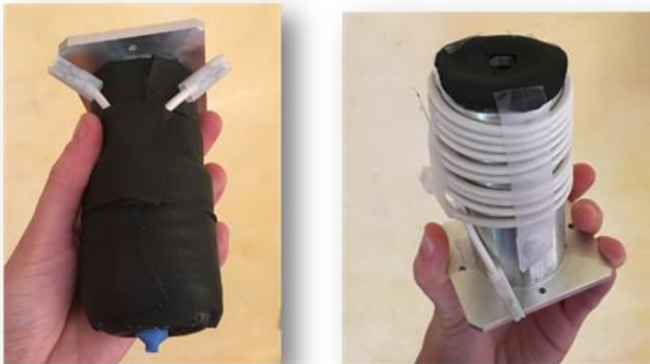
Figura 5.5. Muntatge del capçal amb la resistència de 90 W de potència dissipada.
