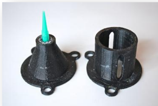
Figura 2.10. Fixacions de la punta extrusora i la xeringa en el capçal. Font: unfoldfab.blogspot.com .
