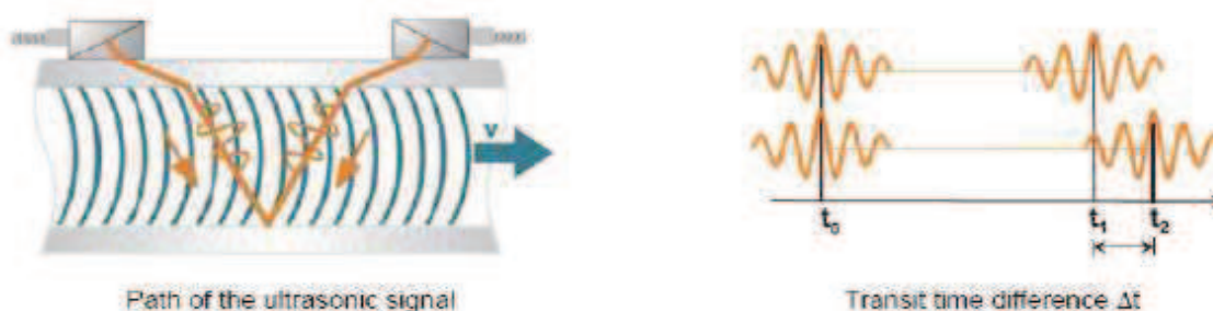
Figura 6.1 Esquema del principi de funcionament del cabalímetre d'ultrasons [2].
