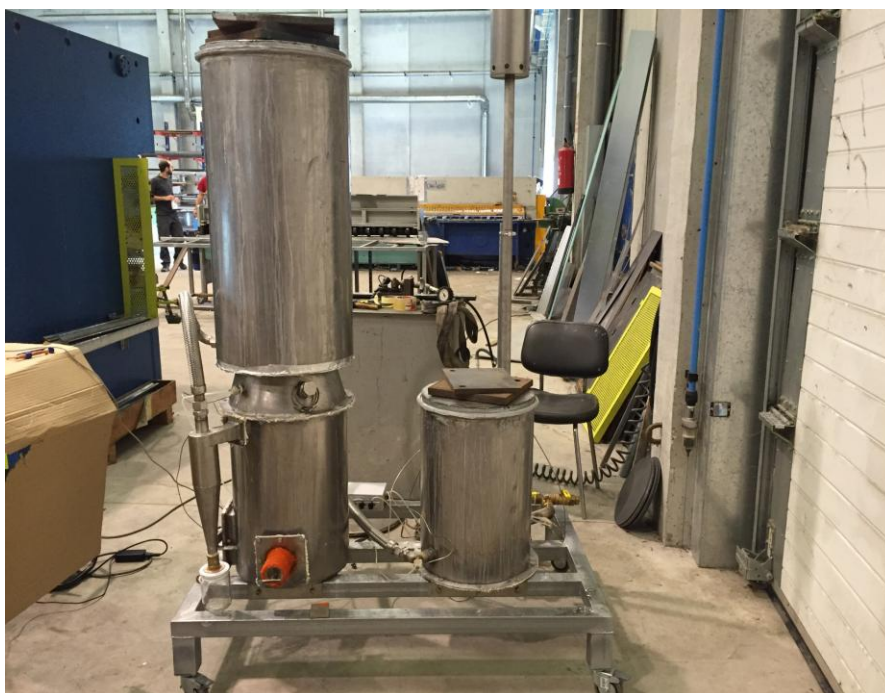
Figura 5 Gasificador CITCEA-UPC en les instal·lacions dels Tallers d’Aspiració a Celler de Ter, Girona. Font: Elaboració pròpia.
