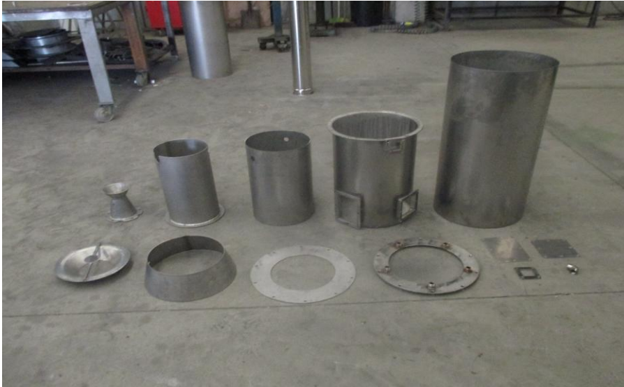
Figura 8 Detall de diverses peces del gasificador preparades per ser muntades entre si. Font: Elaboració pròpia
