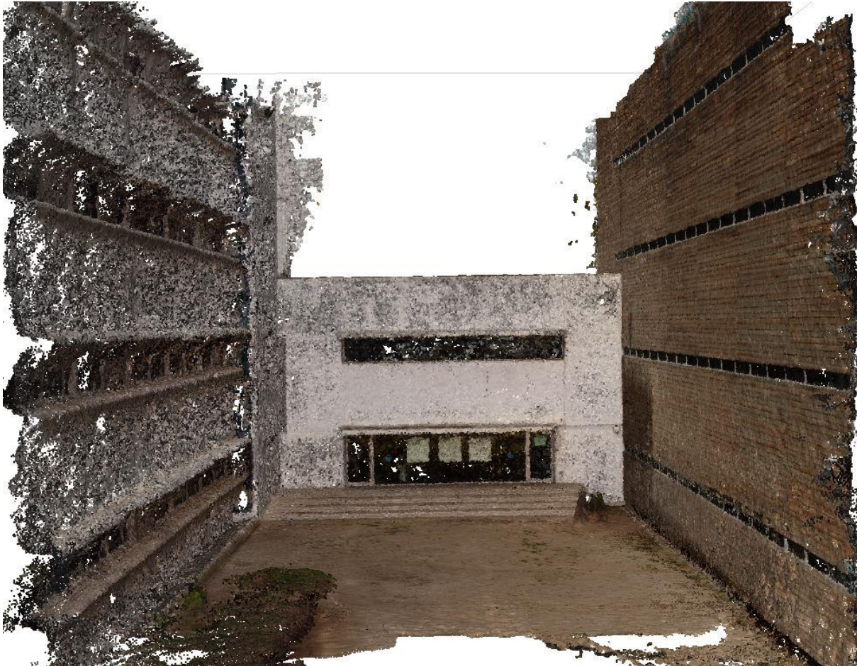
Figura 23 Exemple de núvol de punts generat per fotogrametria.
