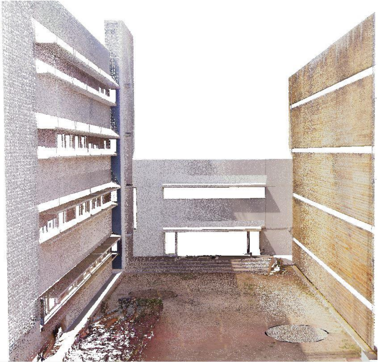
Figura 9 Núvol de punts obtingut amb el làser escàner.
