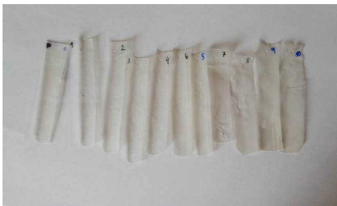
Figura 15: Mostres de REX-PLA que han estat exposades al sol ordenades segons la setmana de recollida
