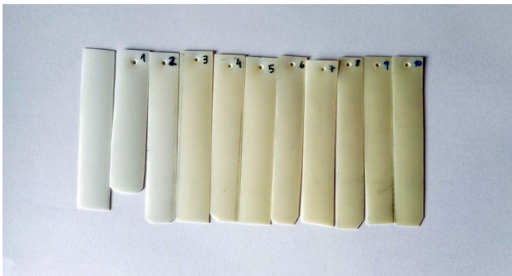
Figura 13: Mostres de la mescla 70/27/3 que han estat exposades al sol ordenades segons la setmana de recollida
