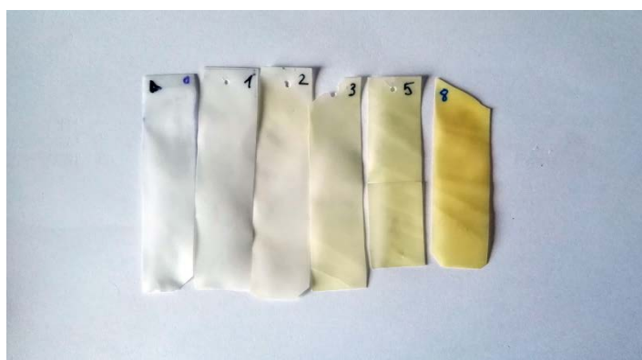
Figura 16: Úniques mostres d'ABS exposades al sol que no es van perdre durant el transcurs de l'experiment
