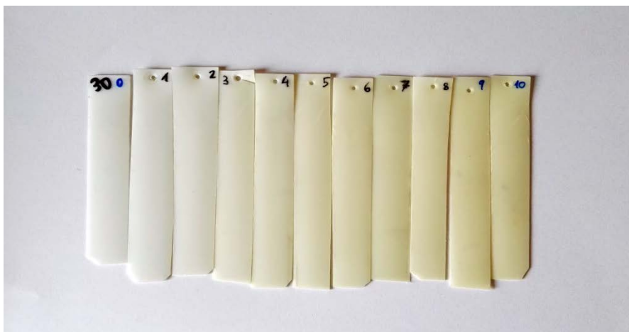
Figura 12: Mostres de la mescla 70/30/0 exposades al sol ordenades segons la setmana de recollida
