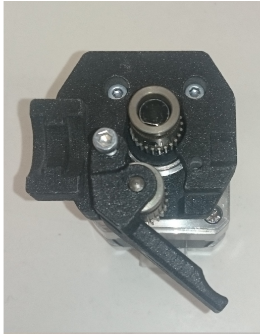
Figura 5.9: Detalle del sistema de acople del segundo engranaje de tracción del extrusor Double Drive Gear desarrollado por BondTech .
