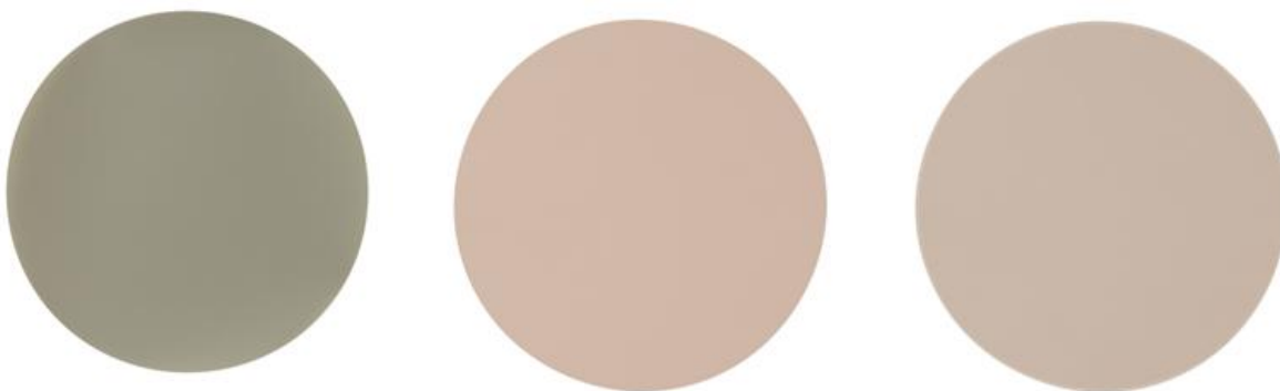
Figura 26. D'esquerra a dreta: Disc de 6 μm, disc de 3 μm i disc de 1 μm
