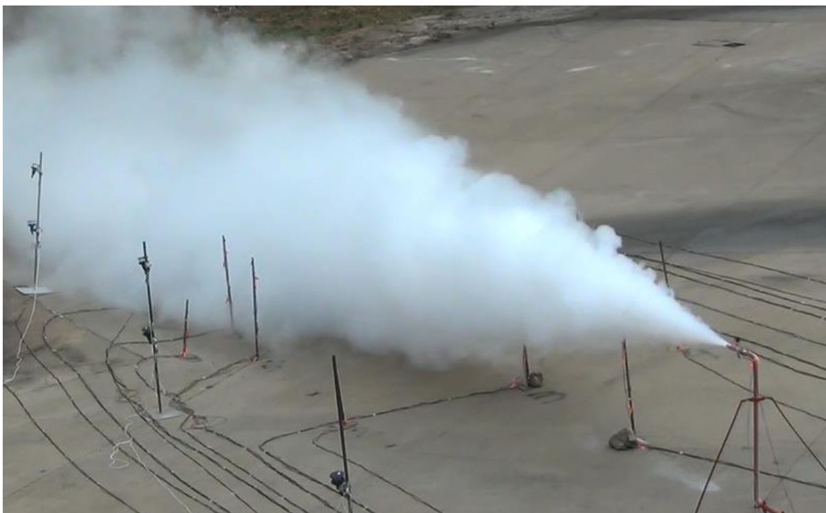
Figura 9- Instant de l'experiment P25_02 captat amb la càmera (Miralles, 2015). Les barres verticals d'acer contenen els diferents sensors utilitzats en l'experimentació.
