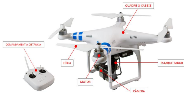
Imatge 1.- Components d’un dron
