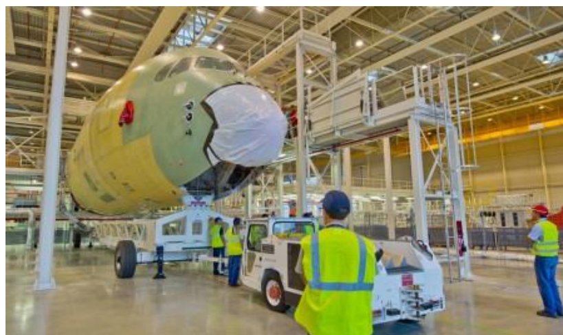
Figura 5. Ensamblaje del avión comercial A350 en la FAL de Airbus Toulouse.
