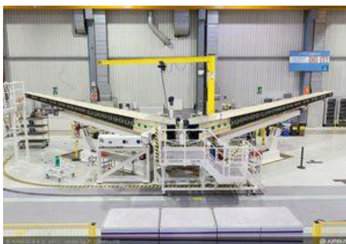
Figura 4. Ensamblaje del Estabilizador Horizontal de Cola de un A350 XWB.
