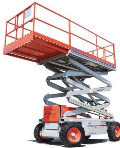
Figura 2. Una plataforma elevable mediante tijeras, se considera una plataforma móvil.
