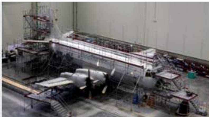
Figura 7. Revisión C de un A400; se usan barras para formar andamios.
