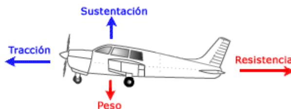
Ilustración 15: Diagrama de fuerzas externas
