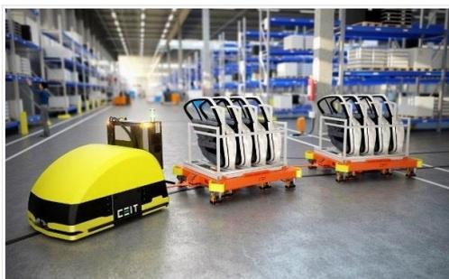
**Figura 20.- Robot CEITruck (Fuente CEIT TI)**
