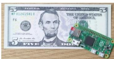
**Figura 27.- Raspberry Pi Zero**
